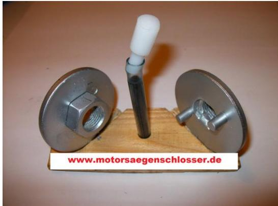
**Universalschlüssel Modell Twin zum lösen der Kupplung von Motorsäge/Kettensägen wie Husqvarna Motorsägen, Dolmar Motorsägen und Importmotorsägen/Kettensägen bis 5 PS
