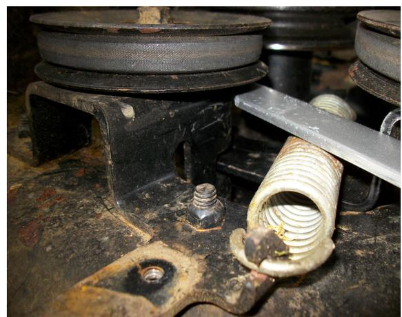
Jetzt wird mit dem Hebel die Spannrolle nach vorn gedrückt. Dann kann man relativ leicht den Mähdeckkeilriemen auf die Messerkupplung montieren, bzw. demontieren
