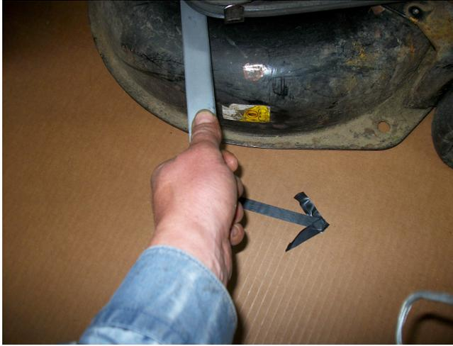
Der Spannhebel ist relativ einfach herzustellen. Man benötigt dazu nur ein Stück Flachstahl 25mm breit und ca.400 mm lang in das man eine Ausbuchtung oder große Kerbe einbringt, damit man beim Spannen nicht abrutscht.
